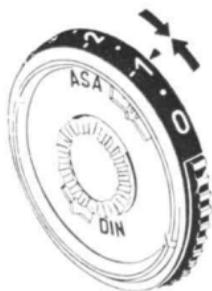
In Ausnahmefällen (Blitzlicht, hohe Filterwerte über -3) berücksichtigt man den Filterwert bei der Belichtung dadurch, daß für jeden vollen Wert eine um 3 DIN verringerte Filmempfindlichkeit zugrunde gelegt wird.
